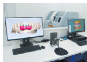
デジタル技術（CAD/CAM）によるブリッジ設計
